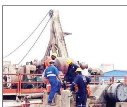
ओएनजीसी ने शुरू किया ड्रिलिंग का काम 100 फिट गहराई में ड्रिल करके उसके अंदर रॉकेट से विस्फोट किया जाएगा। रॉकेट जमीन में करीब पांच से सात किलोमीटर नीचे तक जाएगा। इससे उठने वाली तरंगों का सेंसर मशीन से सर्वे कर डाटा इकठ्ठा किया जाएगा। सेंसर का डाटा परीक्षण के लिए ओएनजीसी भेजा जाएगा। ▶10
